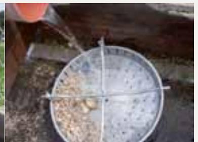
... alle Ablagerungen (Prüfkörper) sind ausgespült, Restwasser fließt noch aus
